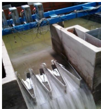
Figura 3. Detalle de ensayo físico con alimentación frontal y aproximación en canal de la primera campaña de ensayos del proyecto POLILAB.
